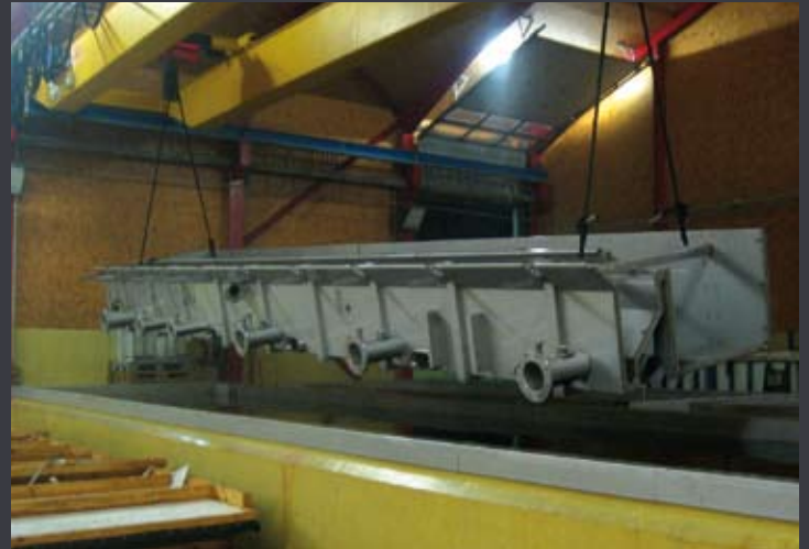
Tauchen eines 12m langen Bauteil ins unser Beizbecken.
